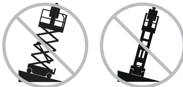
Lutningslarmet ska inte användas som lutningsindikator. Lutningslarmet utlöses på chassit och på plattformen när maskinen står på en sluttning.
